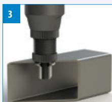
Avvitare l'utensile sul Deform-Nut® ed eseguire la deformazione
