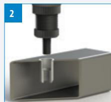
Introdurre il Deform-Nut® nel foro ed azionare l'attrezzo di posa
